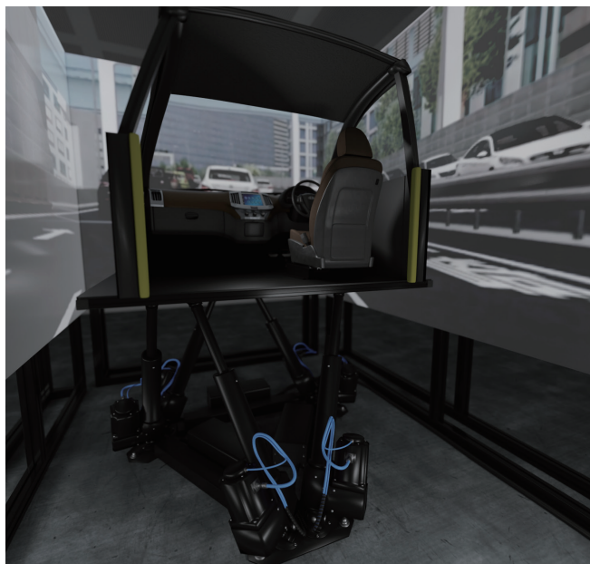
VDX Studio の設備 3面ディスプレイを組み合わせたドライビングシミュレーター環境
